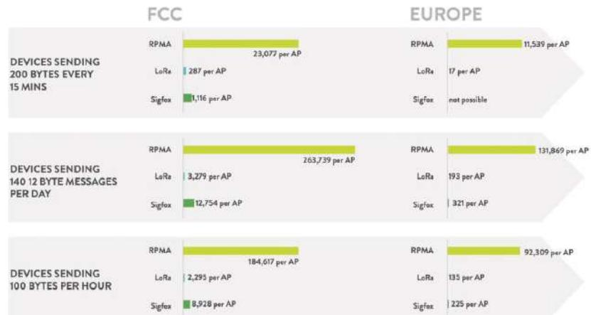
Estos cuadros comparativos muestran lo que un proveedor de aplicaciones o un cliente final obtendría realmente al usar una red RPMA, LoRa o SigFox. Todos los cálculos se basan en métricas de rendimiento técnico obtenidas en campo.
